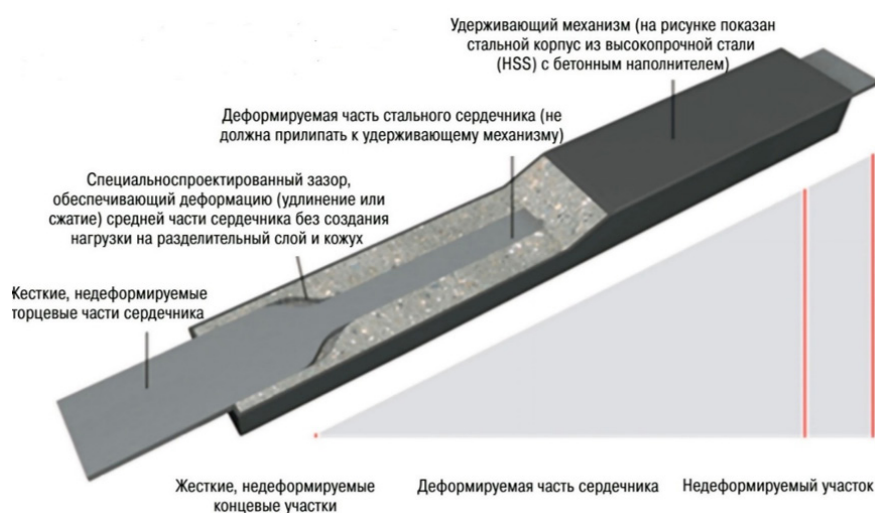
Рисунок 6 – Конструктивное решение BRB-раскоса
