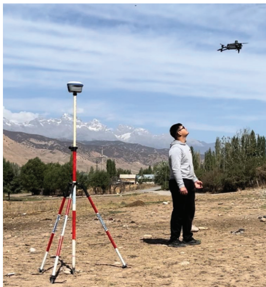
Рисунок 1 – GNSS приемник PRINC i50, квадрокоптер Mavic 3 E RTK [8]
