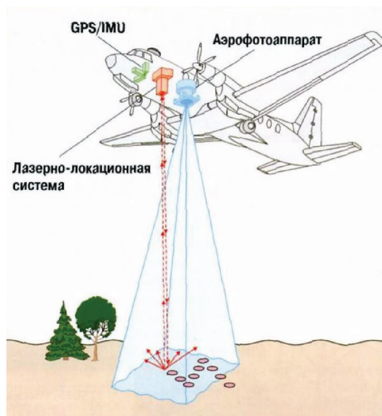
Рисунок 2 – Воздушное лазерное сканирование [9]
